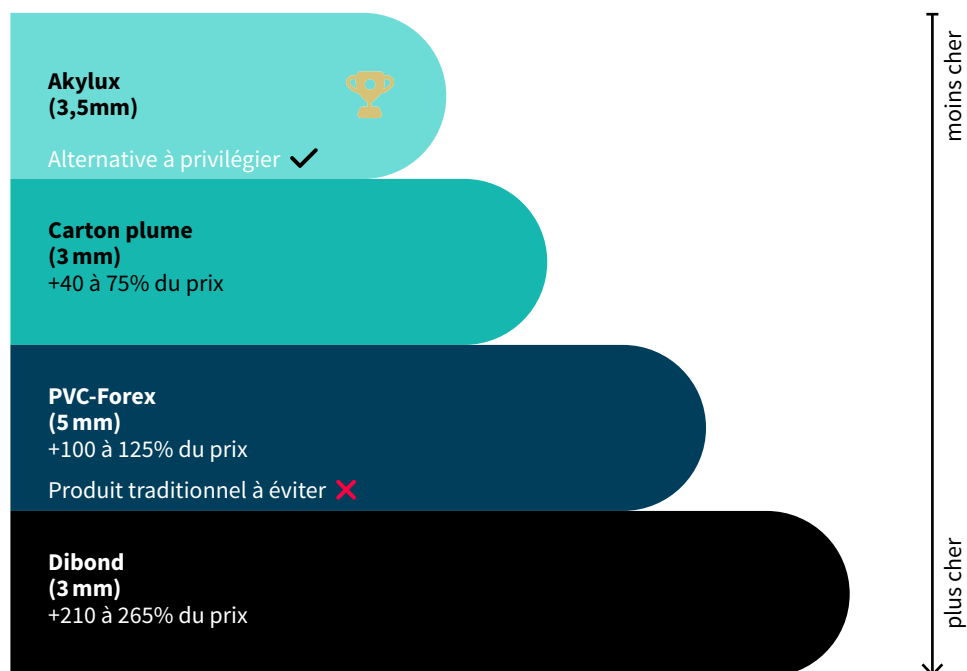
Figure 8 : Classement des matériaux au regard de leurs caractéristiques environnementales et économiques (panneaux rigides)
